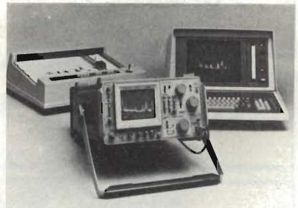
Analizzatore di spettro programmabile funzionante da 50 KHz a 220 GHz.
